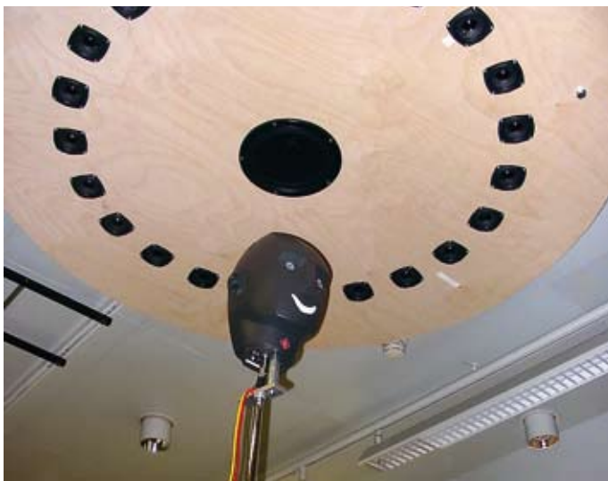
Abb. 4: »Virtueller Kopfhörer«: Ring von 22 Lautsprechern, mit deren Hilfe Schallquellen an die Ohren »projiziert« werden (vgl. Abb. 4) (nach Menzel et al., 2005)
