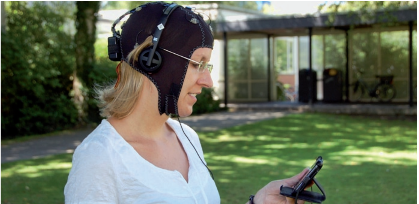
Abbildung 1: Das mobile Oldenburger 14-Kanal-EEG-System mit drahtloser Datenübertragung zu einem Notebook oder Smartphone
